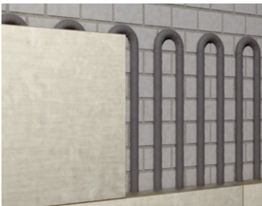
Maschinelles Teilklebeverfahren mit Mineralwolle
