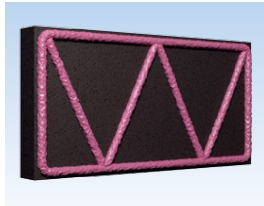
Rand-Wulst-Punkt Verklebung mit RELIUS RELI PUR (EPS-Dämmplatten mit Nut und Feder werden empfohlen)
