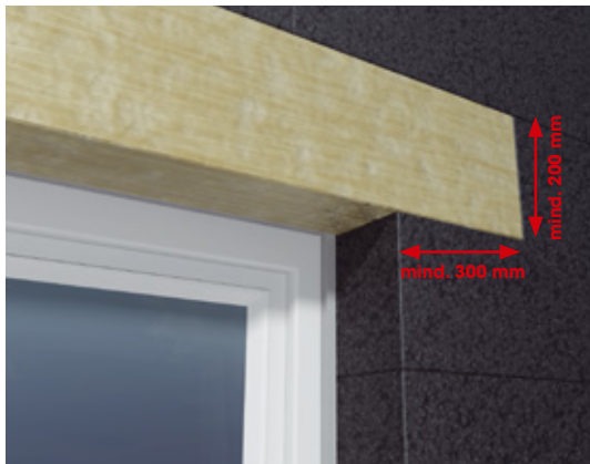
Sturzschutz an Gebäudeöffnungen
